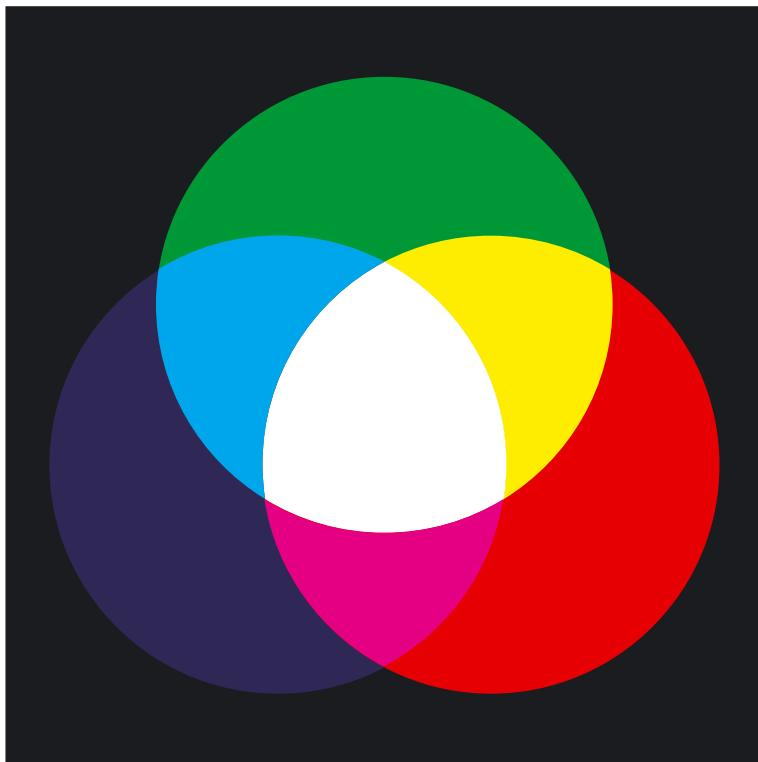
Additive Farbmischung bezeichnet das Mischen von Lichtfarben. Das menschliche Auge kann mit seinen Rezeptoren (Zapfen) drei Farbbereiche des sichtbaren Lichtes verarbeiten. Die drei Grundfarben der additiven Farbmischung sind:
